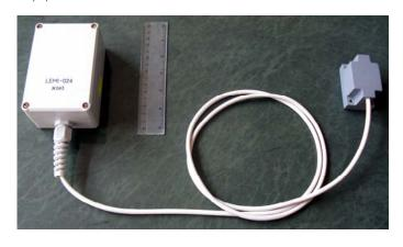
Трехкомпонентный феррозондовый магнитометр LEMI-024 предназначен для измерений трех компонент вектора магнитного поля. Прибор имеет два выхода: не фильтрованный с низкой чувствительностью для грубой оценки напряженности магнитного поля и высокочувствительный фильтрованный выход для измерения слабых флуктуаций магнитного поля в частотном диапазоне 0.01- 10 Гц.
